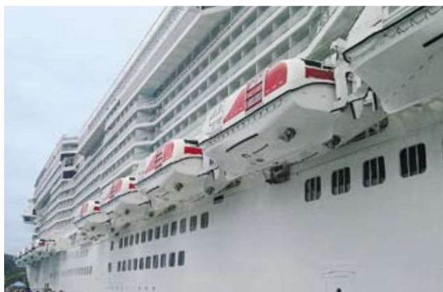
Rettungsboote für Kreuzfahrtschiffe mit einer Kapazität von mehr als 300 Personen je Boot
