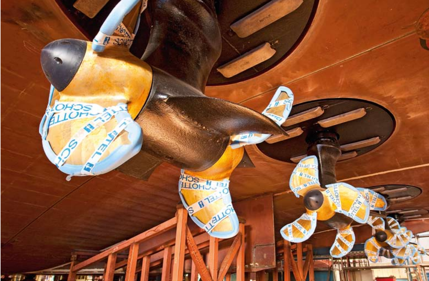
Kraftstoffsparend: Vier direkt angetriebene Propelleranlagen
