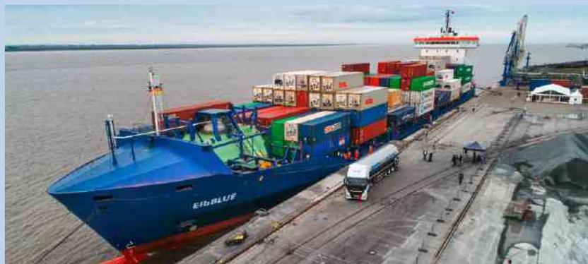
**PREMIERE.** Die „Eibblue“ ist das erste Containerschiff, das mit synthetischem Erdgas (SNG) fährt.
