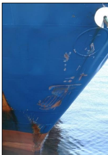
Abbildung 6: Beschädigung Vorschiff MS ELSE oberhalb der Wasserlinie
