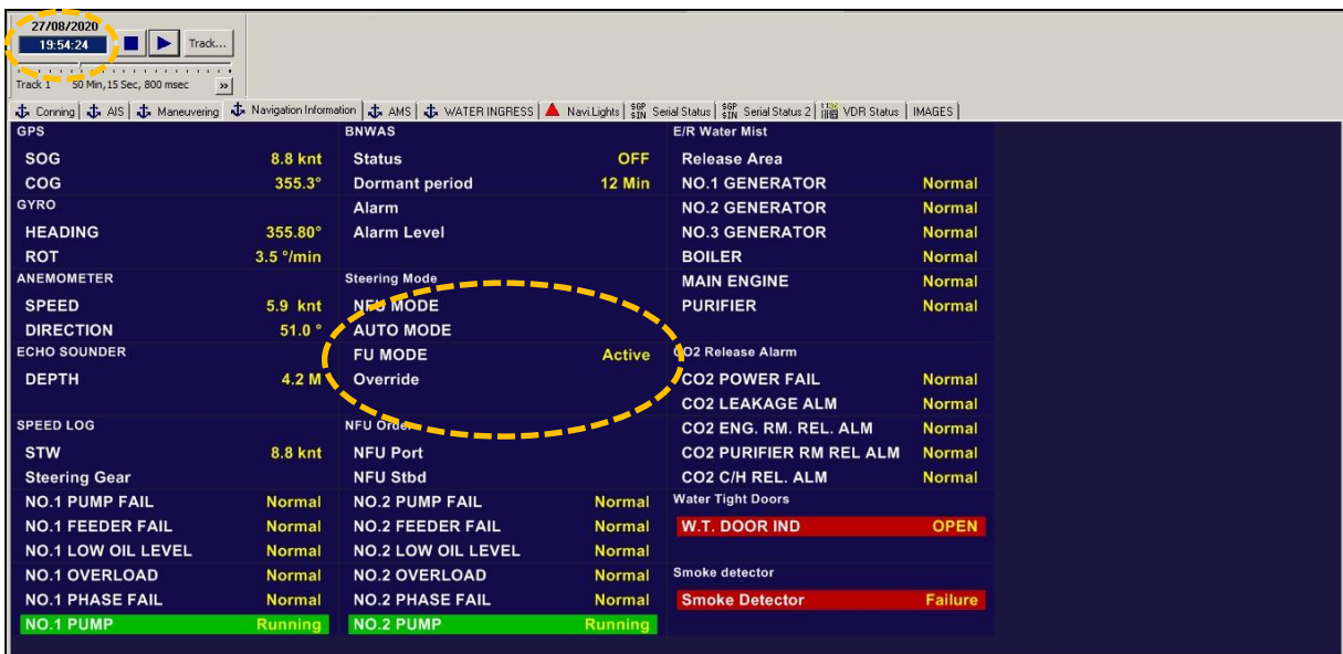
Abbildung 16: VDR: nicht reagierendes Ruder, erstes Auftreten (21:54:24 Uhr Ortszeit)
