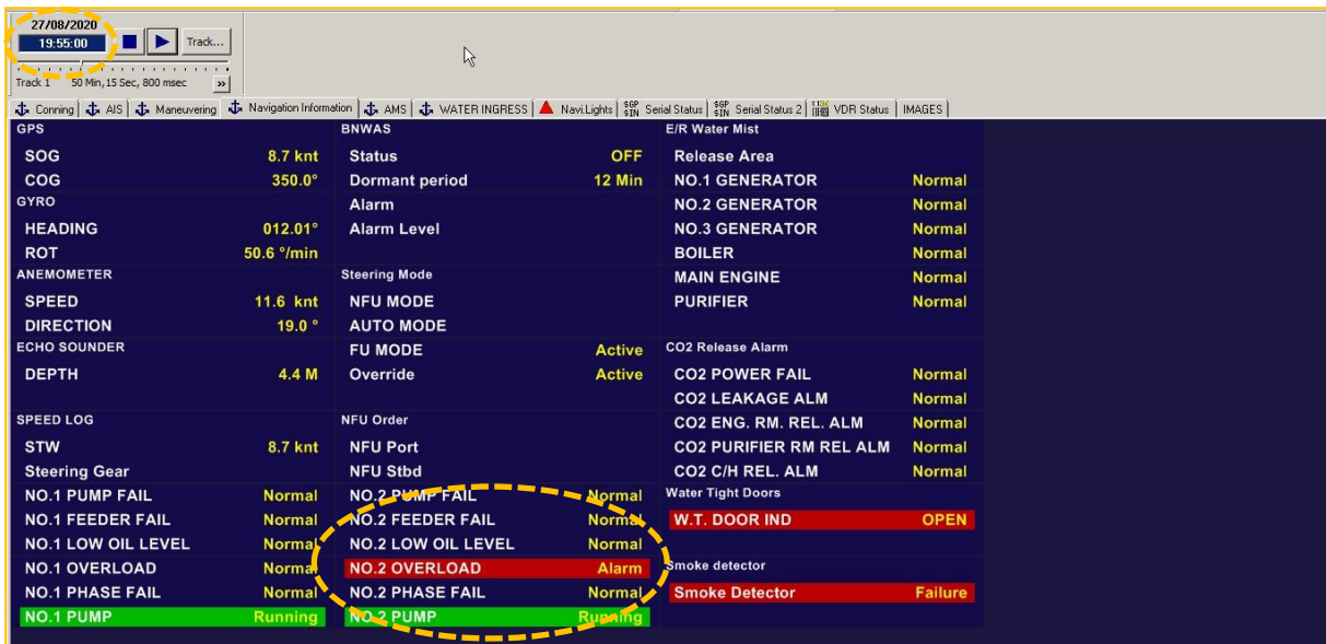
Abbildung 18: VDR: Ruderpumpenalarm (21:55:00 Uhr Ortszeit)
