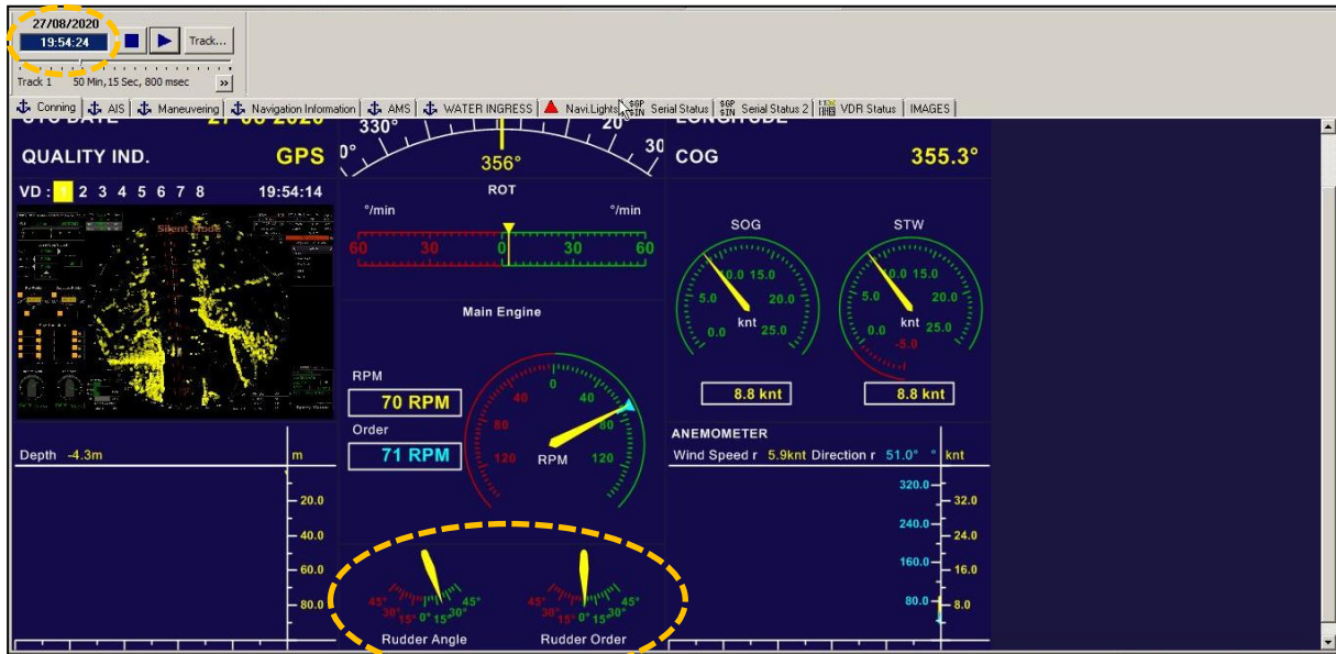
Abbildung 14: VDR: nicht reagierendes Ruder, erstes Auftreten 29 (21:54:24 Uhr Ortszeit)
