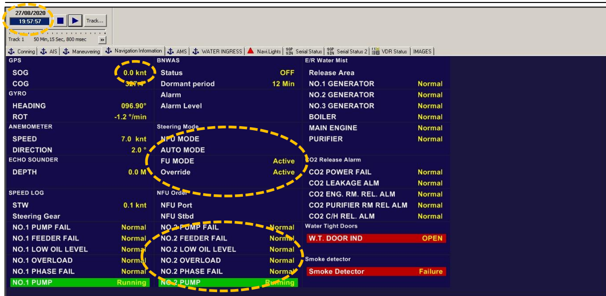
Abbildung 21: VDR: Zeitpunkt des Auflaufs (Geschwindigkeit = 0,0 kn 31 ) (21:57:57 Uhr Ortszeit)
