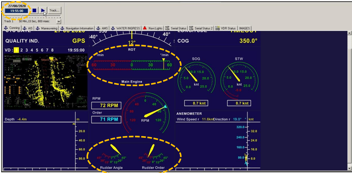
Abbildung 15: VDR: Hartruderlage und ROT ca. 30 s später (21:55:00 Uhr Ortszeit)
