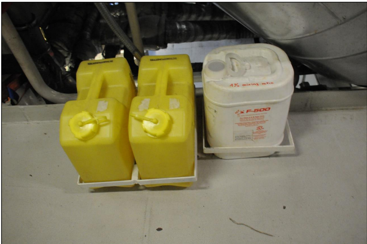
Abbildung 45: Zumischmöglichkeit von Schaum-/Netzmittel oder F-500 EA
