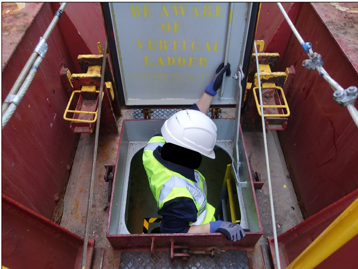
Abbildung 13: Vordere Einstiegs Luke zu Laderaum Nr. 3 55
