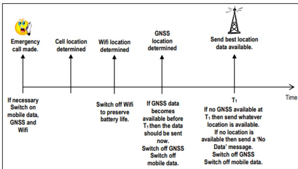
Abbildung 58: AML – zeitlicher Ablauf im Smartphone<sup>167</sup>
