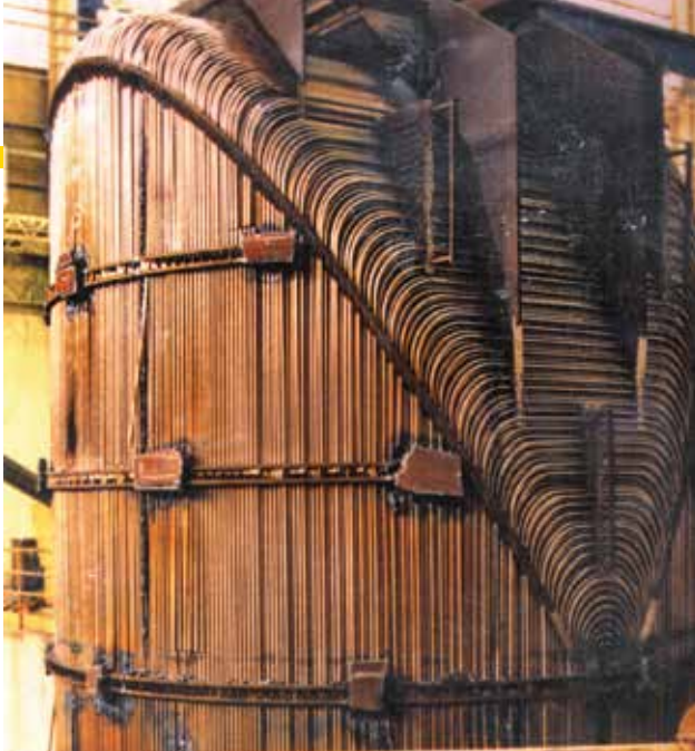
Ein dickes Bündel Heizrohre, u-förmig gebogen – das Innere eines Dampferzeugers, hier ein älteres US-Modell. Ein Austausch dieser Mega-Wasserkocher ist extrem aufwändig und teuer
