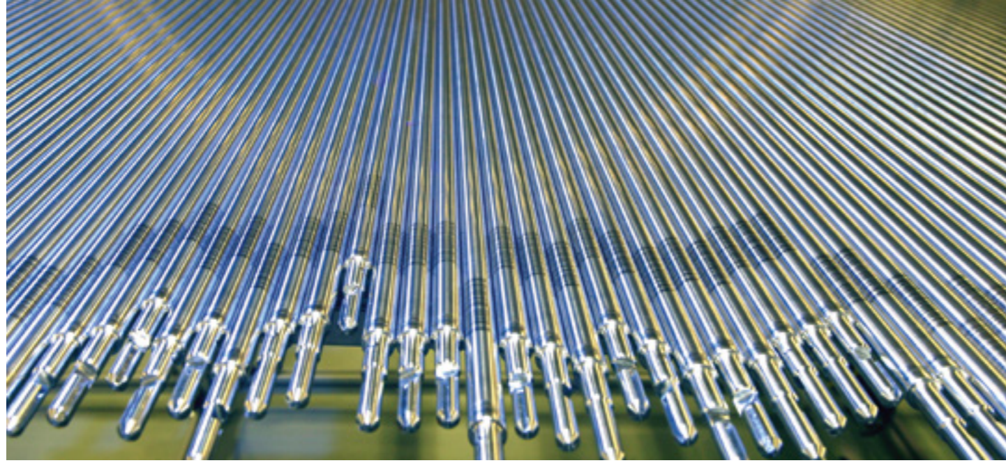
Brennstäbe, noch vor der Montage zu Brennelementen
