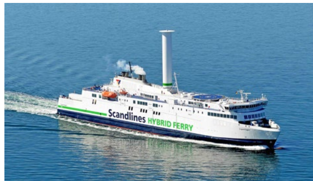
Die Scandlines-Fähre „Copenhagen“ setzt auf Rotortechnik. Ab 2024 startet zwischen Puttgarden und Rødby eine vollelektrisch betriebene Fähre.
