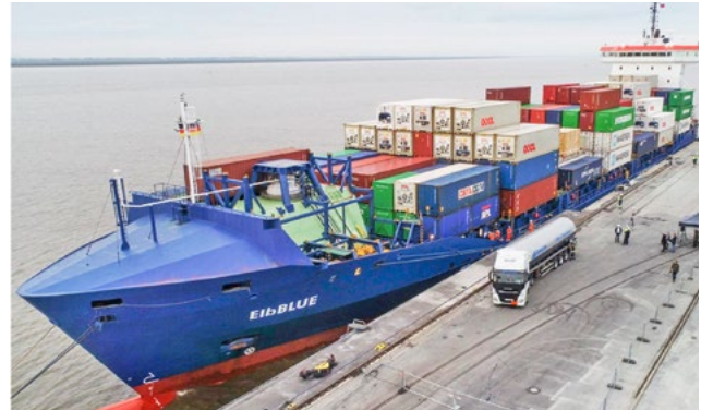
Die „Elbblue“ ist ein mit Wasserstoff betriebenes Schiff.
