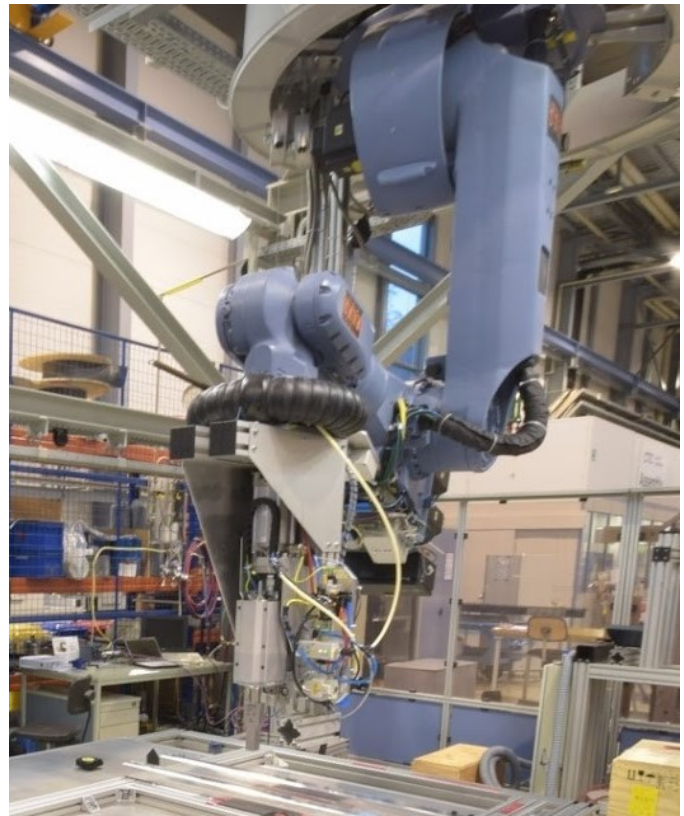
ABBILDUNG 2. 6-ACHS-ROBOTER FÜR DAS ULTRASCHALLSCHWEISSEN AM CTC
