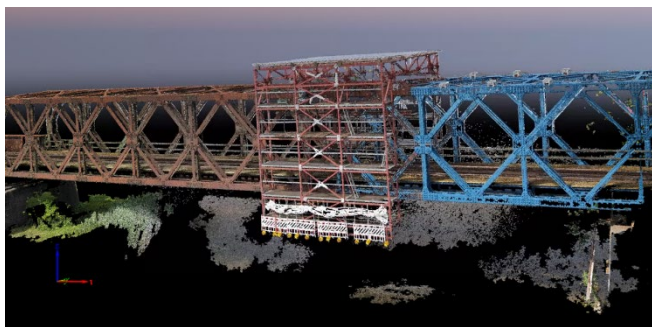
ABBILDUNG 4: AUF BASIS VON RGB-BILDERN PHOTOGRAMMETRISCH ERSTELLTE FARBPUNKTWOLKE DER BAHNBRÜCKE ÜBER DIE OSTE.
