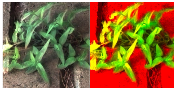
ABBILDUNG 7: PER hNDVI-INDEX UND FALSCHFARBENDARSTELLUNG HERVORGEHOBENE VEGETATION AN DER NORDERELBBRÜCKE AUS EINER HYPERSPEKTRALAUFNAHME.
