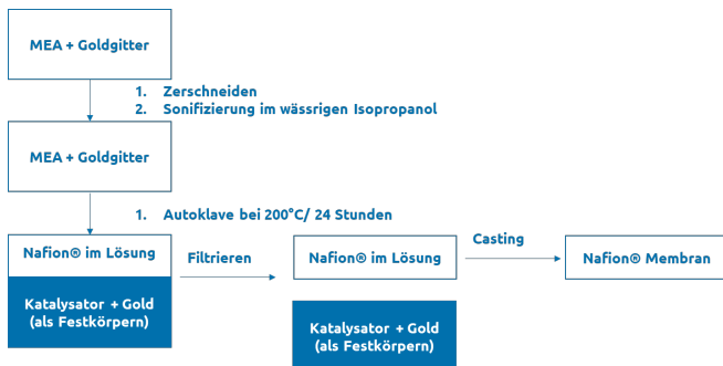
ABBILDUNG 6: WIEDERVERWERTUNG VON NAFION® UND ABTRENNUNG VON KATALYSATORPARTIKELN UND GOLD VON DER MEA.
