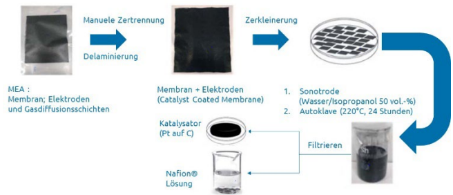
ABBILDUNG 4: WIEDERVERWERTUNG VON NAFION® UND KATALYSATORPARTIKELN DURCH ERHITZEN IN WÄSSRIGEM ISOPROPANOL.
