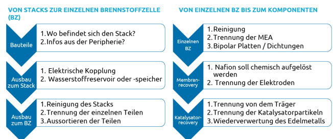
ABBILDUNG 3: SCHEMATISCHER ABLAUF DER ZERLEGUNG EINER POLYELEKTROLYTMEMBRAN- BZ UND EINES STACKS.
