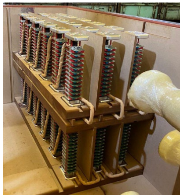
ABBILDUNG 5: B6-DIODENBRÜCKE IN DER TANKEINHEIT.
