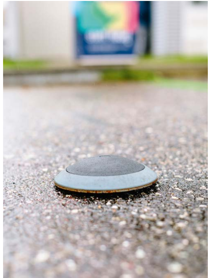
Im Bereich E-Mobilität ermöglicht LoRaWAN, mittels vernetzter Bodensensoren freie Parkräume vor den Ladepunkten zu identifizieren.
