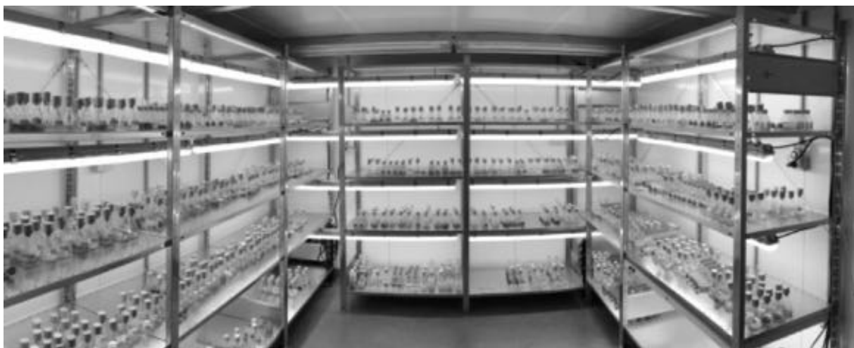
Abb. 1: Thermokonstantraum zur Anzucht von Mikroalgen in der Hamburger Mikroalgensammlung MZCH (Foto K. v. Schwartzberg).
