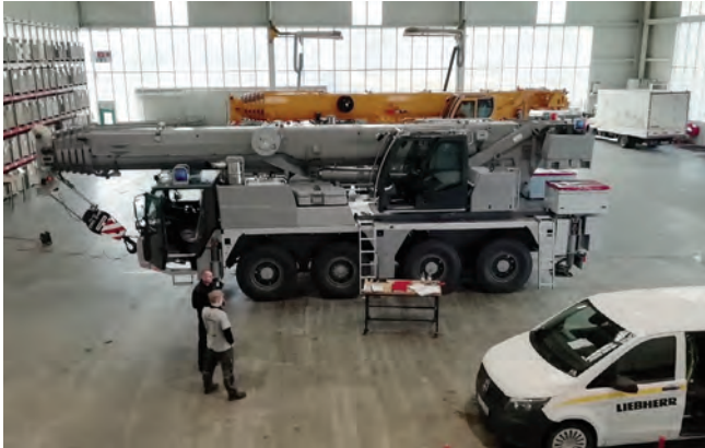
Rohbauabnahme: Der Rohbau ist im Werk in Ehingen fertig gestellt und wird durch F03 abgenommen
