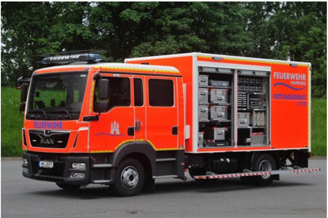
**Der neue GW-SAN:** Aufbau und Beladung des Fahrzeuges ermöglichen einen schnellen und effizienten Aufbau einer Patientenablage für bis zu zehn Personen pro Stunde
