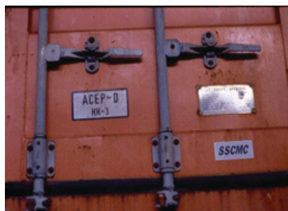
Containerverschlüsse mit Plomben. Darunter Hersteller- und Zollzulassung
