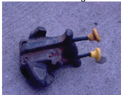
Twistlock zum Befestigen der Container
