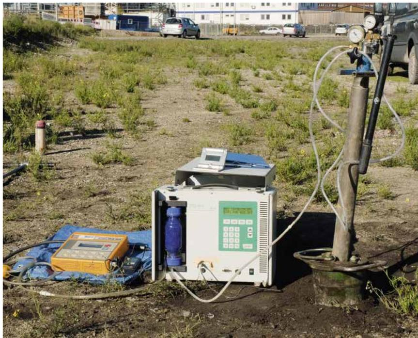
Messsystem bestehend aus Packersonde, Pumpe und Deponiegasanalysator
