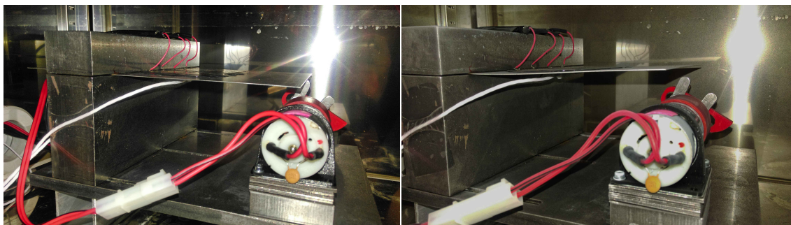
Abbildung 10: Vergleich des Teststands bei 20 °C (links) und bei -40 °C (rechts)
