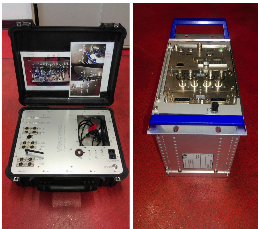
Abbildung 2: Links: Mobiler Messkoffer der GL Garrad Hassan Deutschland GmbH , rechts: Mobiles Messmodul der imc Berlin GmbH
