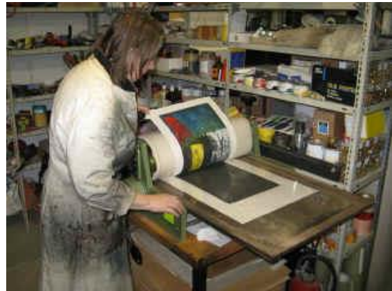
Druck einer Radierung an der Radierpresse
