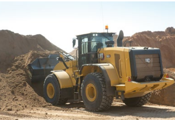
Der neue Cat 966 GC mit 239 kW Motorleistung und rund 22 Tonnen Einsatzgewicht. (Foto: Caterpillar/Zeppelin)
