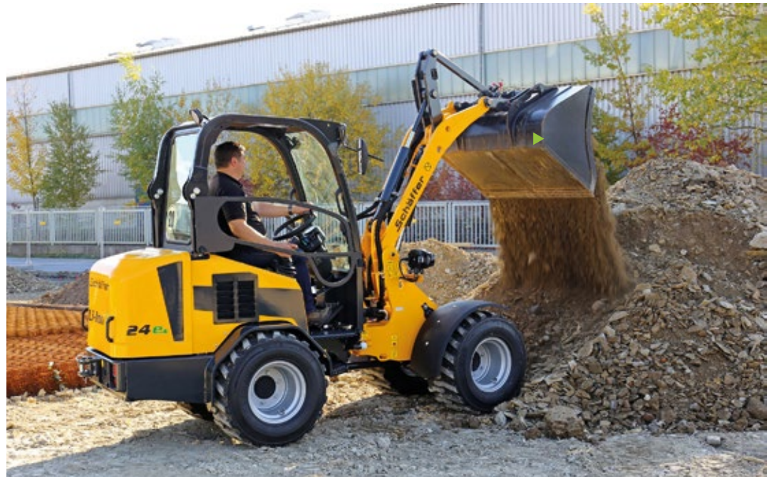
Ganz ohne Emissionen ist der Schaeffler Elektrolader 24e im Einsatz. Angetrieben von Lithium-Ionen-Akkus und mit elektrischem Direktantrieb reduziert er die Betriebskosten auf ein Minimum. (Foto: Schaeffler Maschinenfabrik GmbH)
