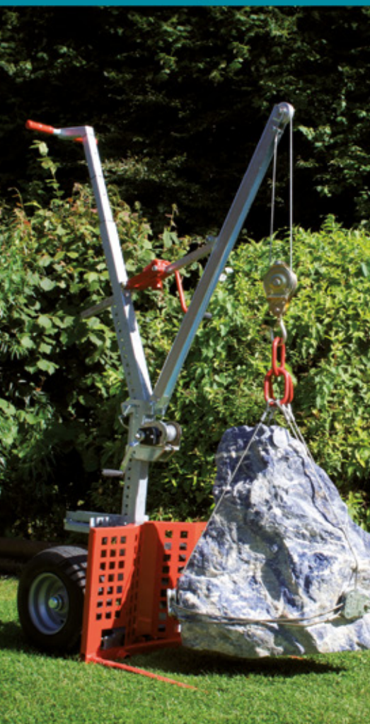
Kran zum Anheben, Transportieren und punktgenauem Absetzen von Findlingen und Quellsteinen
