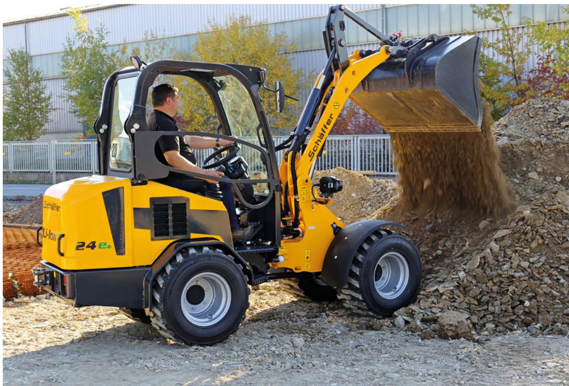
Ganz ohne Emissionen ist der Schäffer Elektrolader 24e im Einsatz. Angetrieben von Lithium-Ionen-Akkus und mit elektrischem Direktantrieb reduziert er die Betriebskosten auf ein Minimum. (Foto: Schäffer Maschinenfabrik GmbH)
