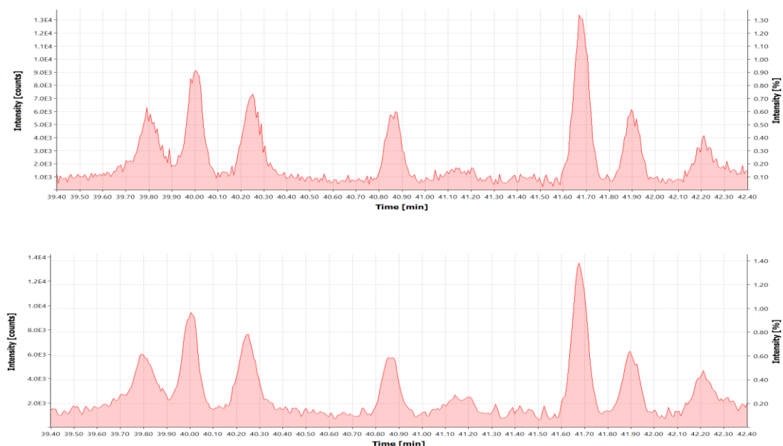
Abbildung 29: Savitzky-Golay Smoothing - oben Rohdaten, unten geglättet - Ausschnitt aus Blindprobe 05, RT 39,40 – 42,40 Minute (OP53837).
