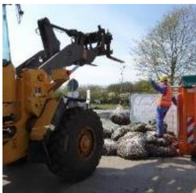
Bestimmung der Netzmasse mit Kranwaage
