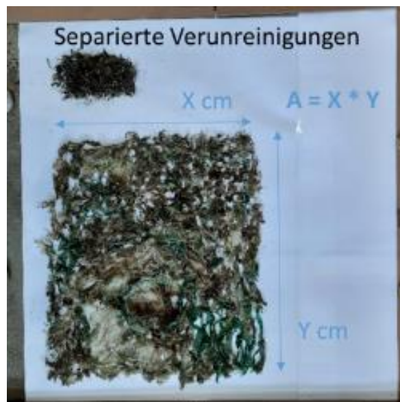
Abbildung 15: Bestimmung der Flächenzahl der aus den Netzen ausgelesenen BAK-Makropartikel (A – Flächenzahl)
