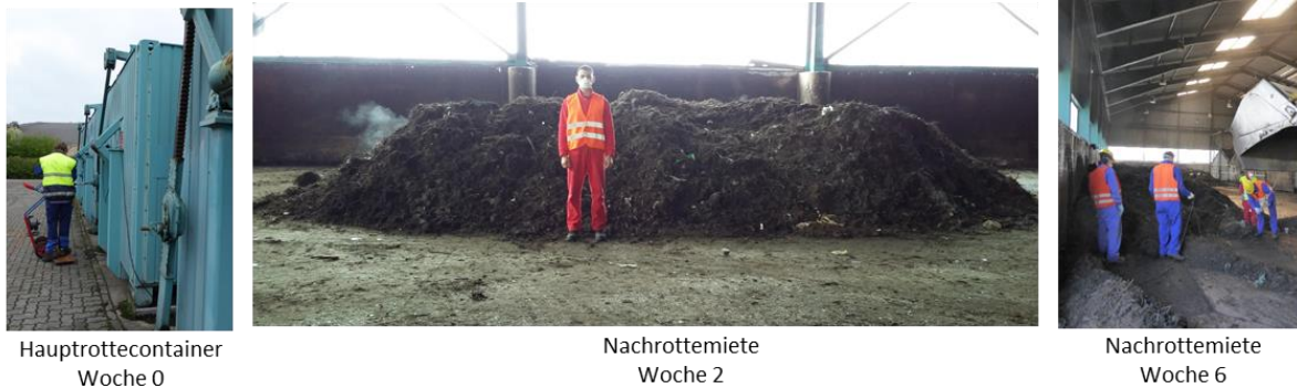
Abbildung 3: Hauptrottecontainer sowie Nachrottemiete zu Beginn und am Ende der Nachrotte
