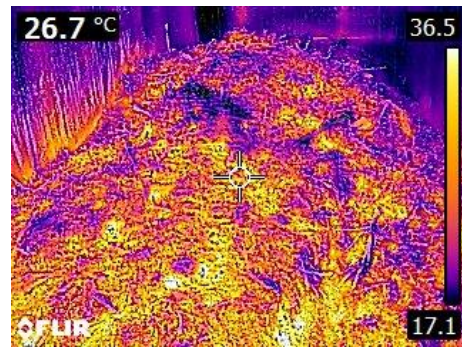
Gradienten der Oberflächentemperatur am Beispiel des Containers 32133
