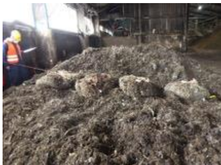
Platzierung der Netze in der Nachrotte
