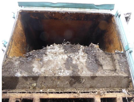
Feuchtegradienten am Beispiel des Containers 32152
