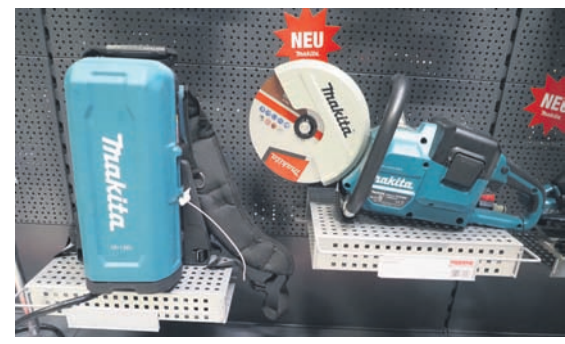
Der große Trennschleifer kann mit einem PowerPack angetrieben werden – verstaut in einer Art Rucksack.
