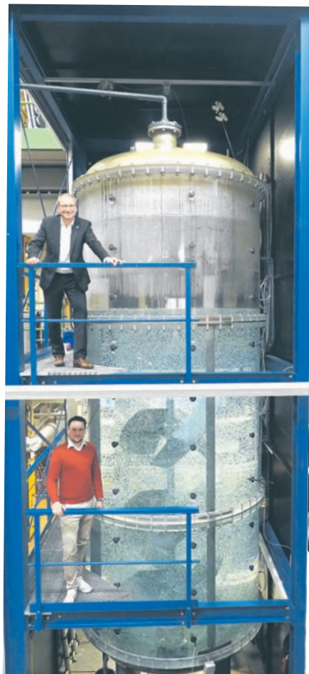
Prof. Michael Schlüter (oben) und sein Doktorand Jürgen Fitschen vor dem gläsernen Reaktor im Technikum der TU Hamburg. Der Behälter fasst 15 Kubikmeter und hat eine sieben Zentimeter dicke Wand aus Acrylglas.
