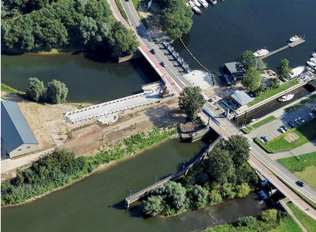
**Abb. 1:** Luftbild der Staustufe Doesburg mit 5-feldrigem Wehr, fertiggestellter Fischaufstiegsanlage, Schleuse und Vorfluter (am unteren rechten Bildrand) (Bild: Waterschap Rijn en IJssel, 09/2019)
