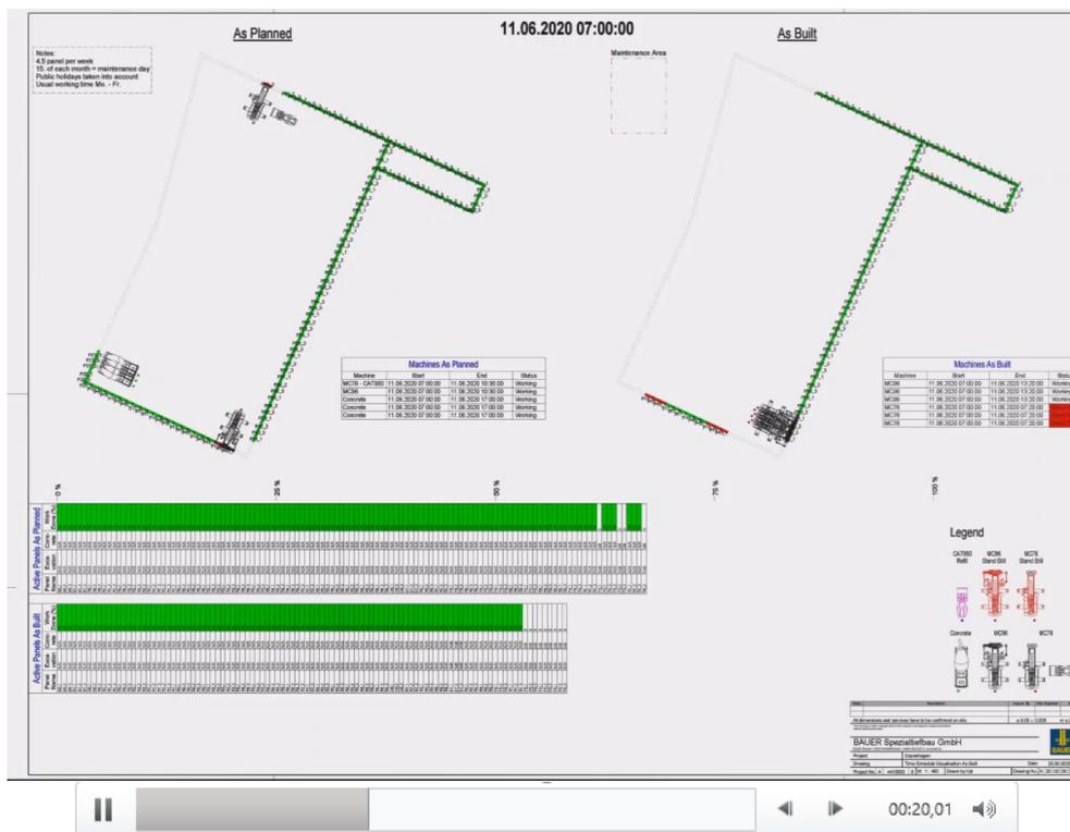
Abb. 12: Die Schlitzwand in der planmäßigen (links) und tatsächlichen (rechts) Entstehung
