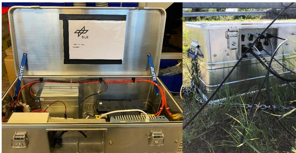
**Abb. 3:** Sensorverarbeitungsboxen mit IndustriePC, Backup-Batterie und verschiedenen Netzwerk-Schnittstellen
