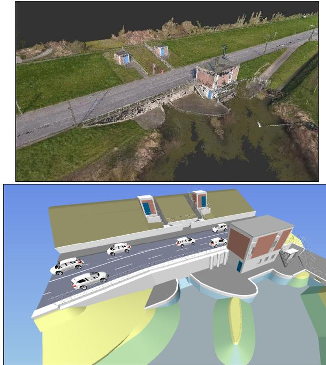
**Abb. 9:** oben: Ausschnitt aus der Punktwolke im Bereich des Siele- und Schöpfwerkes Neuenfelde, unten: 3D-Modell der Planung des Siele- und Schöpfwerkes Neuenfelde
