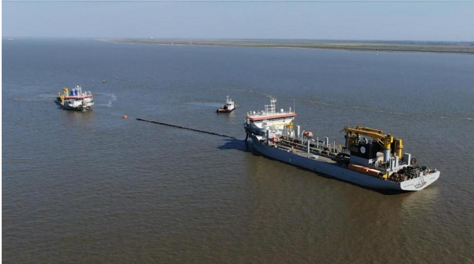
**Abb. 6:** Übergabe des Baggerguts in der BE-Fläche der UWA Neufelder Sand vom großen auf den kleinen Hopperbagger; Abkoppeln des kleinen Hoppers von der Spülleitung
