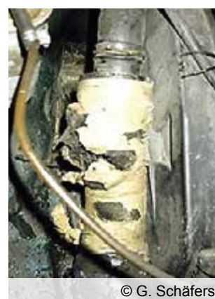
Abb. 7.29: Vom Steinmarder zerbissener Kühlschlauch.
