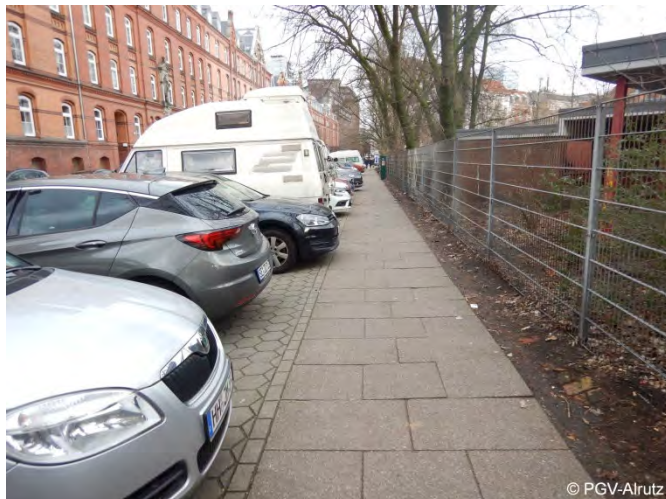
Abb. 6-4: Hauptschulweg entlang von Hütten nördlich des Enckeplatz: stark eingeengt durch Senkrechtparken. Als Einbahnstraße ist eine weniger breite Fahrbahn hinter den Fahrzeugen erforderlich, so dass dann der Gehweg verbreitert werden kann. (Quelle: PGV-Alrutz)
