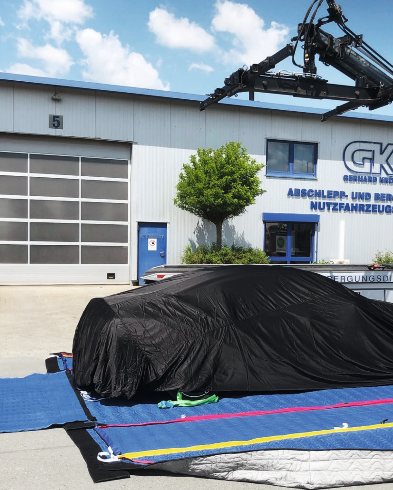
Eine spezielle Brandschutzdecke verhindert, dass das Fahrzeug nach einer Selbstentzündung der Lithium-Ionen-Akkus in Flammen aufgeht.
