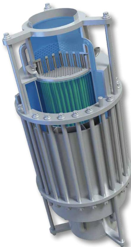
Kern eines Dual-Fluid-Reaktors mit getrennten Brennstoff- (grün) und Kühlkreisläufen (blau).
