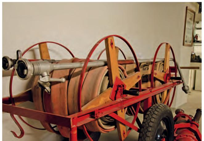
Löschanhänger mit Schlauchhaspeln und Löschanzen
