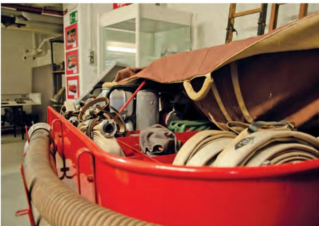
Handzug-Löschkarre mit Tragkraftspritze, Saug- und Rollschläuchen, Mehrzweckstrahlrohren, Verteiler, Rettungstuch und Kraftstoffkanister
