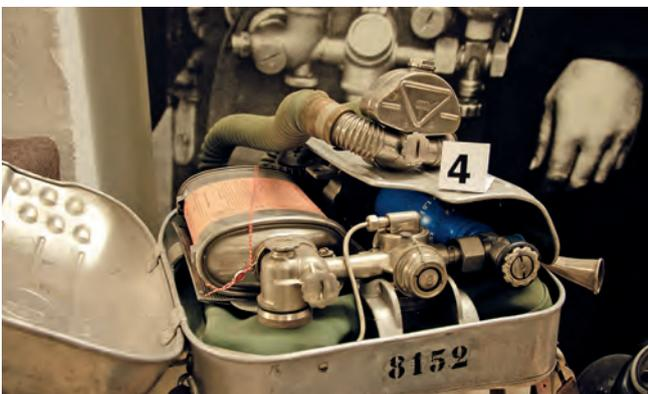
Sauerstoffschutzgerät, auch Kreislaufgerät genannt, da die ausgeatmete Luft nach Anreicherung mit Sauerstoff und Durchströmung durch eine Regenerationspatrone wieder dem Gerät zugeführt wird
