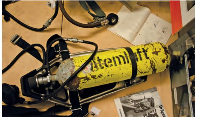
Ein-Flaschen-Pressluftatmer, Atemluftvorrat: 1800 Liter, Behälterfülldruck 300 Bar
