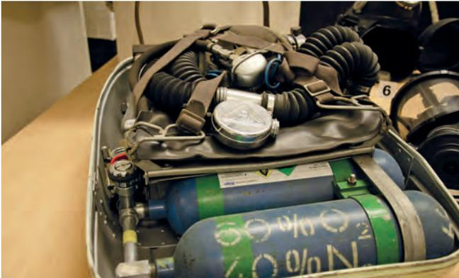
Mischgas-Atemschutzgerät für Langzeiteinsätze. Die Atemluft besteht aus einem Gemisch von 60 Prozent Sauerstoff und 40 Prozent Stickstoff
