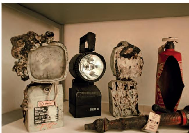
Im Brandeinsatz zerstörte Ausrüstung: Handlampen (links und mitte), Mehrzweckstrahlrohr (vorn), Handfeuerlöscher zerborsten (rechts hinten)
