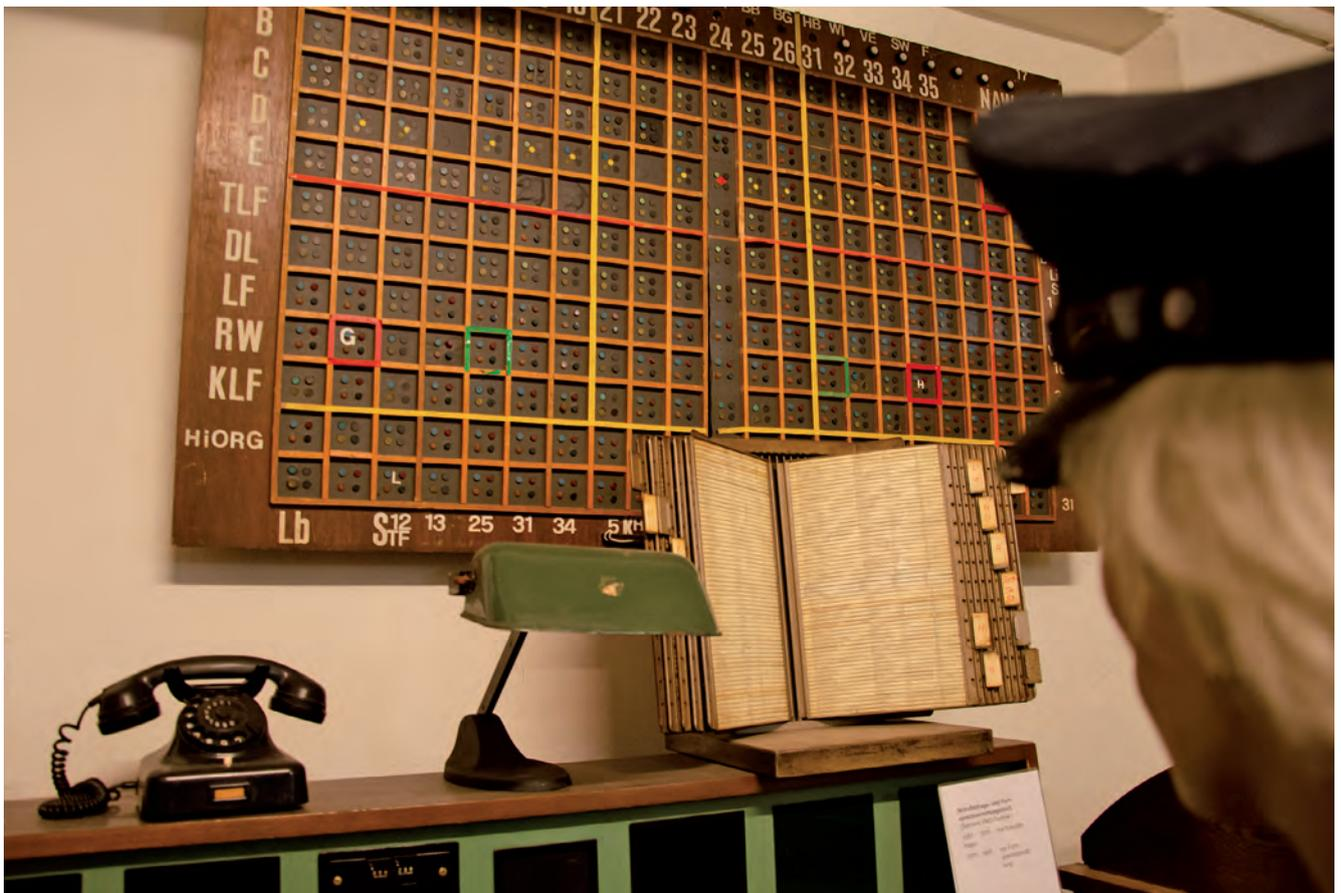
**Optische Signale:** Die Erfassung der Verfügbarkeit der Einsatzfahrzeuge erfolgte ab 1967 über einen Vorläufer der großen Wartenwand und einem dazu gehörigen Switchbord (unten), auf dem die Einheiten per Handdreheschalter in den entsprechenden Status geschaltet wurden
