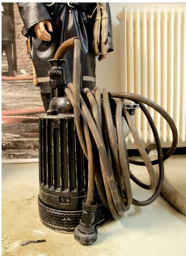
Elektro-Tauchpumpe mit Kabel und wettergeschütztem Schutzkontaktstecker
