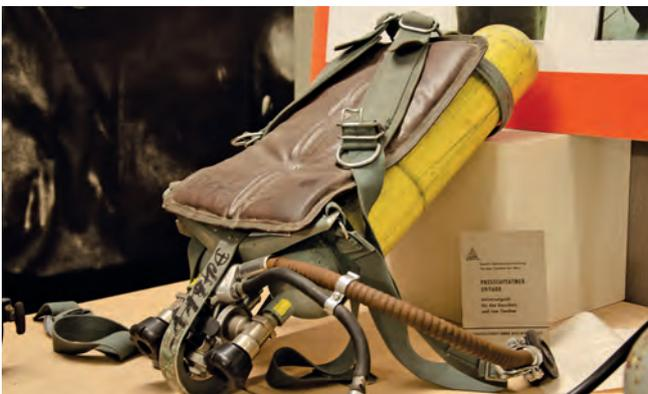
Zwei-Flaschen-Pressluftatmer, Atemluftvorrat: 1600 Liter, Behälterfülldruck 200 Bar
