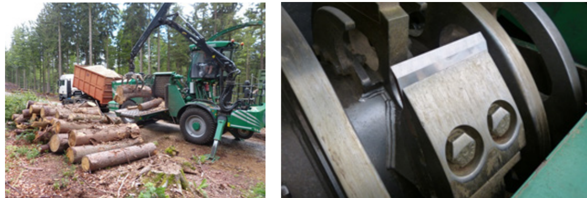
Abbildung 1: Eingesetzter Hacker Albach Diamant 2000 und neue, scharfe Messer (Quelle: TFZ)
