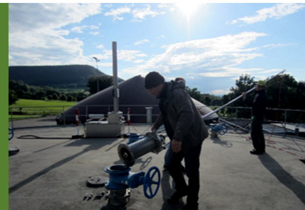
Abbildung 1: Integration des Sensorkopfes in Ventilaufsatz zur Multipositionsmessung (oben). Aufsatz des Sensorkopfmoduls auf Ventileinbauten im Reaktordeckel (unten).
