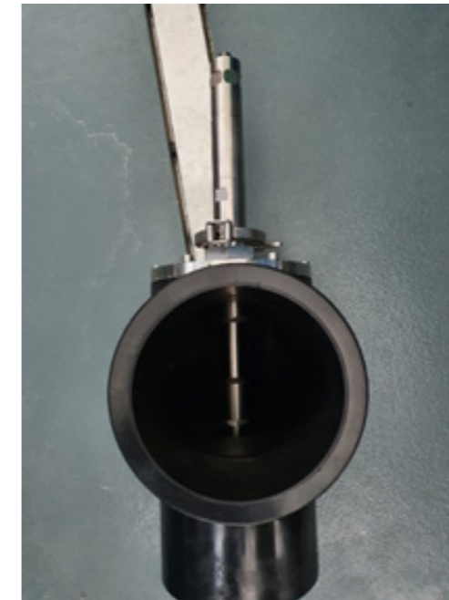
Abbildung 1: Ultraschallsonotrode im Bypass Abbildung 2: Aufbauprinzip optische Einheit - Tiefenbeweglicher selektiver Fokus
