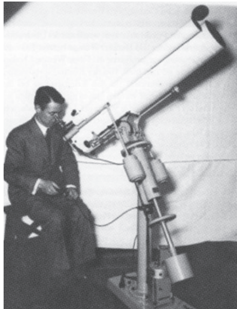
Der Gummelt-Artrograph (160mm Öffnung/Brennweite 800mm) mit dem Beyer die Aufnahmen der Sternfelder anfertigte.
