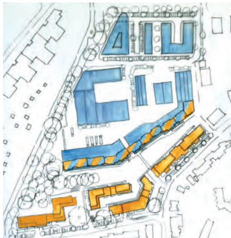
Abb. 1: Gewerbe (blau), Wohnen (beige) und dazwischen ein Hybridriegel mit Beidem (gestreift). Die Behörde nennt das „Robustes Wohnen“.
