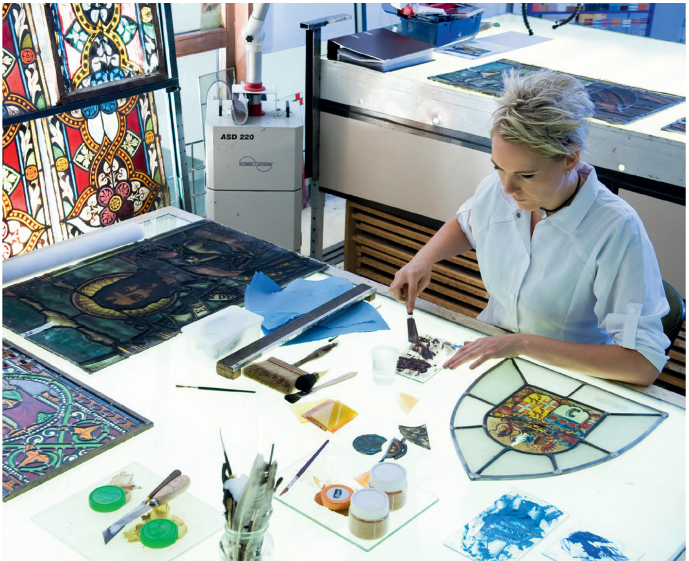
Eine Restauratorin trägt bleihaltige Farbpasten bei mittelalterlichen Glasmalereien auf.
