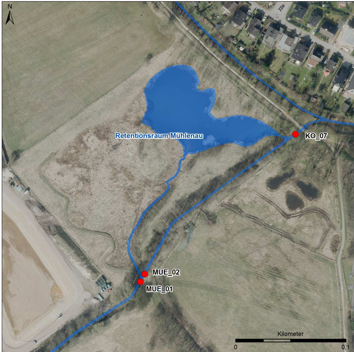
Abb. 11: Wasserfläche im Retentionsraum Mühlenau im IST-Zustand mit Abflussmessstellen des LSBG (Kartengrundlage LGV 2017).
