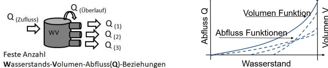
Abb. 2: Schema und Funktion einer stationären Wasserstands-Volumen-Abfluss-Beziehung eines Hochwasserrückhaltraumes im numerischen hydrologischen Modell.
