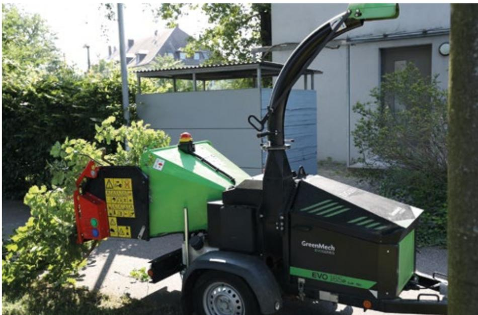
Mit 3,1 m Transportlänge und einem Gesamtgewicht von gerade einmal 750 kg parkt der kompakte Evo 165 P locker auf dem Gehweg.
