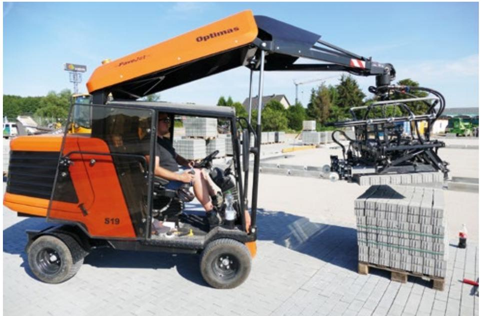
Optimas bietet jetzt auch die Heben/Senken Funktion per Joystick an. Genau wie beim Bagger (Foto: Optimas)
