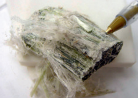
Chrysotilasbest mit sich ablösenden, feinen Asbestfasern
