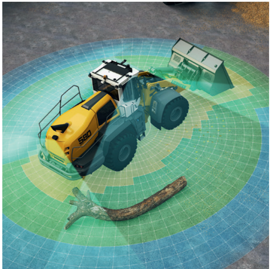
Rückfahrkameras an Radladern zählen zu den Präventionsmaßnahmen, die von der VBG im Rahmen des Prämienverfahrens für die Branche Glas und Keramik gefördert werden.
