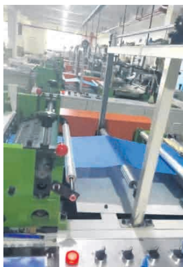
Ein Blick in die Fertigung: Die Handschuhe werden aus Folie gestanzt und verklebt – dieses Verfahren unterscheidet sich grundlegend von der Produktion üblicher Gummihandschuhe. Foto: ReiKo aproTex
