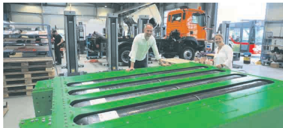
Die Wasserstofftanks stehen nach dem Einbau aufrecht direkt hinter dem Führerhaus der Zugmaschine. Die Brennstoffzelle wandelt Wasserstoff in Strom um, mit dem die Elektromotoren angetrieben werden. Aus dem „Auspuff“ kommt reines Wasser.
