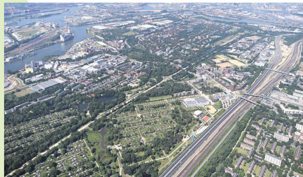
Das Luftbild zeigt die alte Reichsstraßen-trasse (links) und die neue entlang der Bahn (rechts). Der Rückbau läuft auf Hochtouren (oben, rechts).
