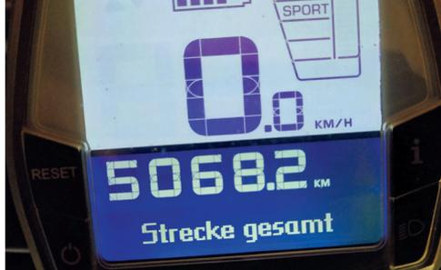
Auf den modernen Tachometern der E-Bikes lassen sich jederzeit Daten wie Unterstützungsgrad, Kilometerstand, Tempo und Reichweite ablesen.
