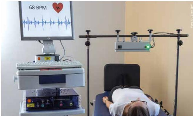
Die Messung von Herzschlag und Atmung erfolgt kontaktlos: Im „BrainEp“-Projekt soll die Radartechnik allerdings unter dem Bett eingebaut werden.
