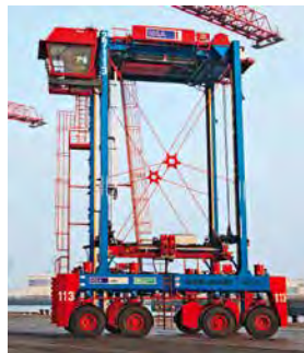
Die HHLA nahm 2019 im Hamburger Hafen den weltweit ersten Hybrid-Van-Carrier in Betrieb. Er nutzt überschüssige Energie, die etwa beim Bremsen entsteht, für das Fahren.
