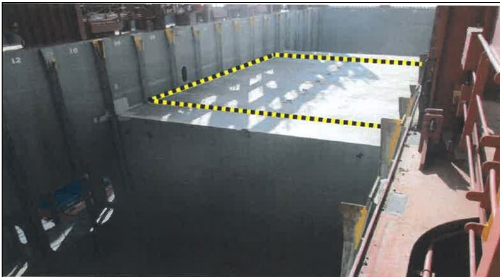
Abbildung 25: FLEET CIRCULAR – Markierungen zur Warnung vor Absturzgefahr 77
