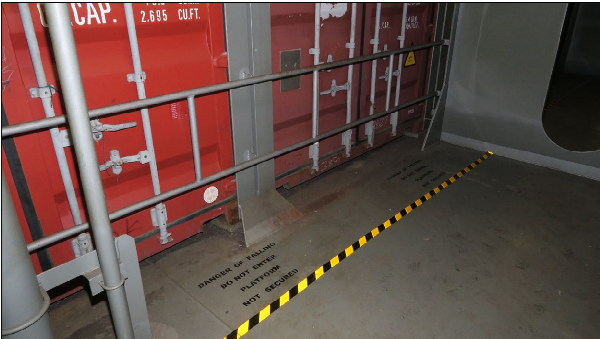
Abbildung 29: Ein anderer gegen Absturz abgesicherter Bereich der SAJIR 81
