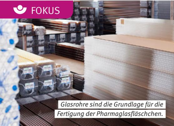
*Glasrohre sind die Grundlage für die Fertigung der Pharmaglasfläschchen.*
