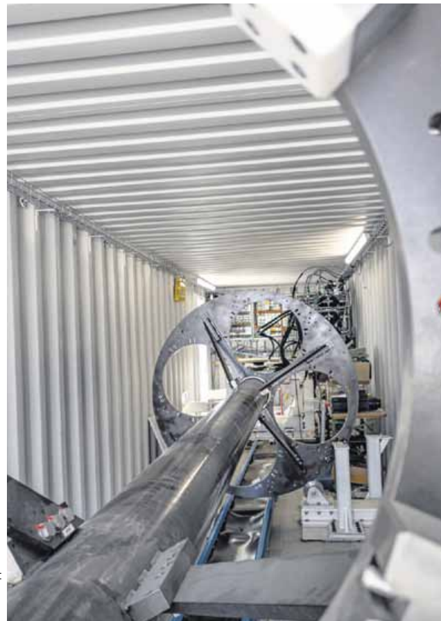
Ausgeklügeltes Konzept: Ein Rohrlager, welches Platz für vier Stück bietet, ist das Herzstück der Tunnelbohrmaschine. Diese ist in einem Container verbaut.
