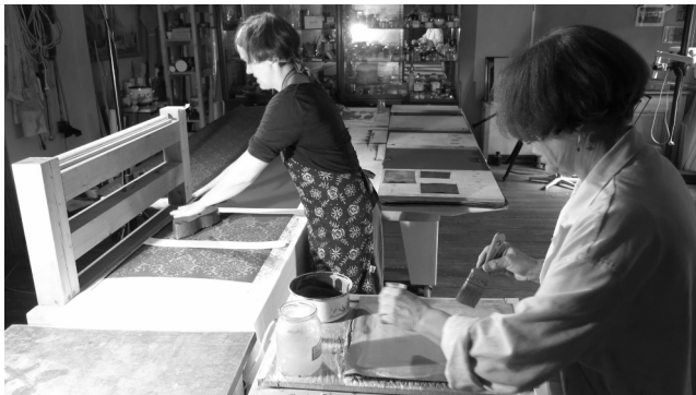
Abb. 6: Der bauzeitliche Befund von Tapetenresten machte die Rekonstruktion der Tapeten in einem komplizierten und aufwendigen Verfahren mittels Modeln in Handdrucktechnik möglich – genau so hatte der Maler der Brehms gearbeitet (Brehms Welt – Roland Horn)
