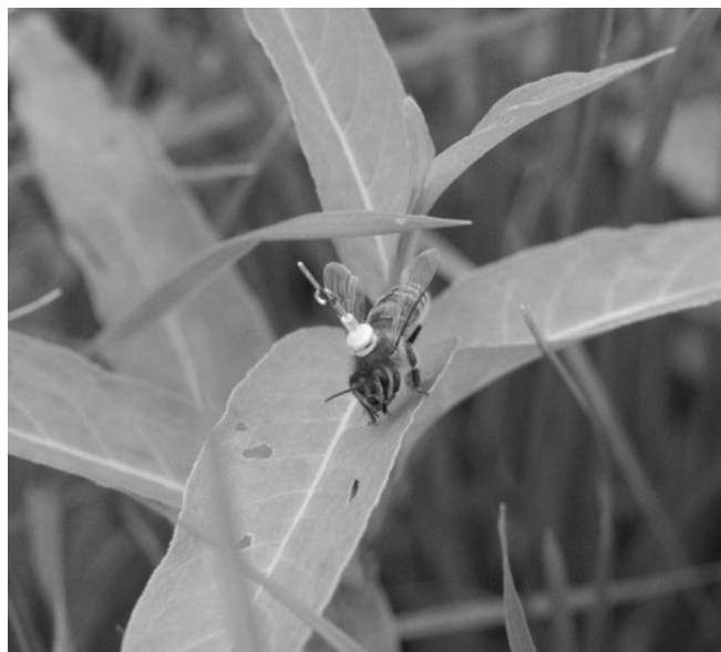
Der Flug einer Biene kann mit dem harmonischen Radar im Umkreis von ca. 1 km verfolgt werden. Dazu trägt die Biene einen Transponder für die Radarstrahlung, der eine harmonische Frequenz aussendet. Der Transponder wiegt nur etwa 13 mg und stört den Flug der Biene nicht.
