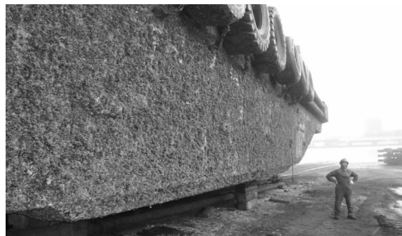
Abb. 4: Typischer Schiffsbewuchs, vorwiegend Seepocken ex: Micanti
