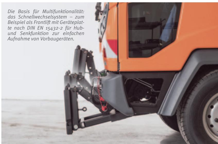
Die Basis für Multifunktionalität: das Schnellwechselsystem – zum Beispiel als Frontlift mit Geräteplatte nach DIN EN 15432-2 für Hub- und Senkfunktion zur einfachen Aufnahme von Vorbaugeräten.
