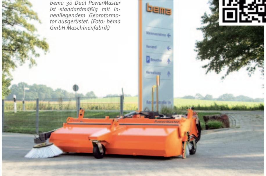
bema 30 Dual PowerMaster ist standardmäßig mit innenliegendem Gerotormotor ausgerüstet. (Foto: bema GmbH Maschinenfabrik)
